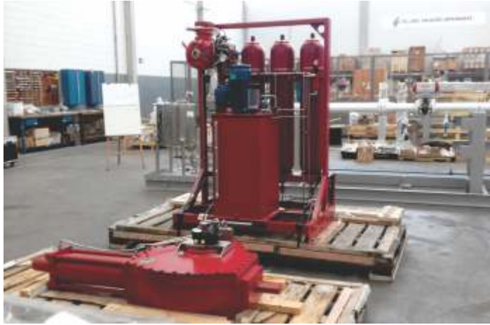
Atuador Eletro-Hidráulico Rotork em galpão de serviços da Fluxo
